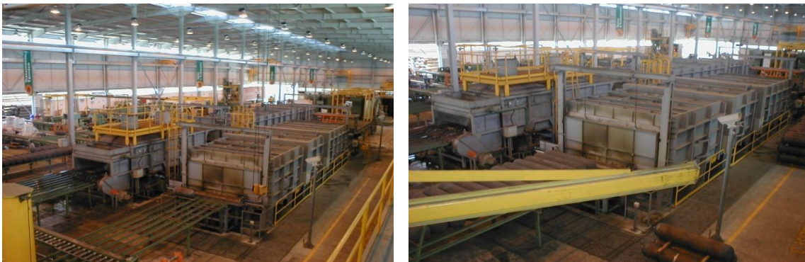
Figura 1: Forno de Têmpera e Revenido.
