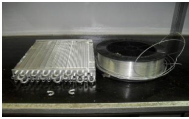
Figura 8. Trocador de calor e material de adição usada para teste da plataforma experimental.
