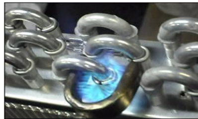
Figura 9. Teste da plataforma experimental na brasagem do trocador de calor.
