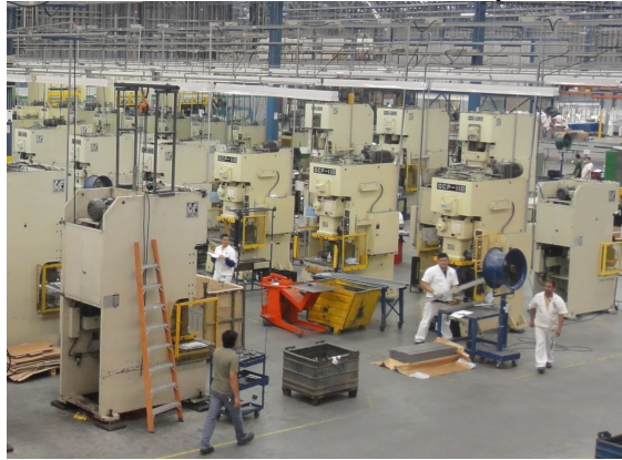
Figura 5 – Vista parcial de los motores y general del cuerpo metálico de las prensas
