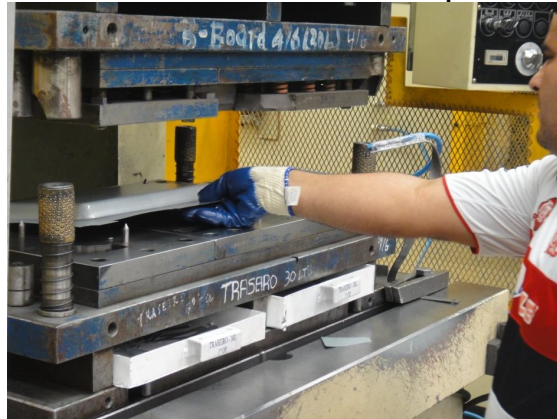
Figura 7 – Pico de aire sin punta adecuada
